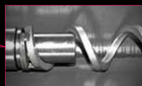
机内螺旋排屑器 (KF4600 选项)
